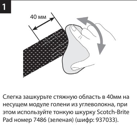
Слегка зашкурьте стяжную область в 40мм на несущем модуле голени из углеволокна, при этом используйте тонкую шкурку Scotch-Brite Pad номер 7486 (зеленая) (шифр: 937033).
