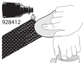
Rengjør enden av karbonfiberrøret og innsiden av klemhuset grundig. Bruk et passende løsemiddelbasert rengjøringsmiddel, slik som aceton (928412). La tørke. IKKE HÅNDTER RENGJORTE OMRÅDER.
