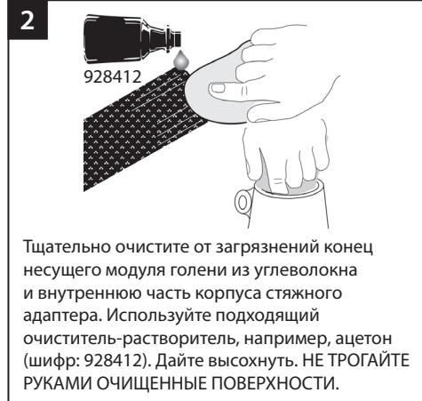
Тщательно очистите от загрязнений конец несущего модуля голени из углеволокна и внутреннюю часть корпуса стяжного адаптера. Используйте подходящий очиститель-растворитель, например, ацетон (шифр: 928412). Дайте высохнуть. НЕ ТРОГАЙТЕ РУКАМИ ОЧИЩЕННЫЕ ПОВЕРХНОСТИ.
