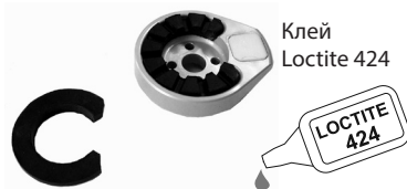
Рис. 2. Установка амортизатора плантарфлексии средней жесткости
