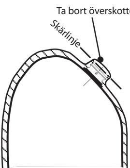
1. Drapera hylsan, bygg ned den om det behövs för att möjliggöra tillverkning av ytterhylsan. Knyt av runt ventilhöljet för att säkerställa god tätning mellan ventilhöljet och hylsan.
