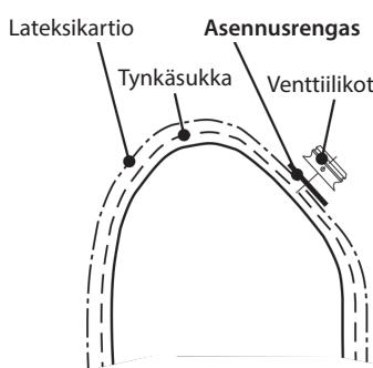
1. Paina kipsimuottia kasaan siitä kohdasta, johon venttiliili kiinnitetään.
