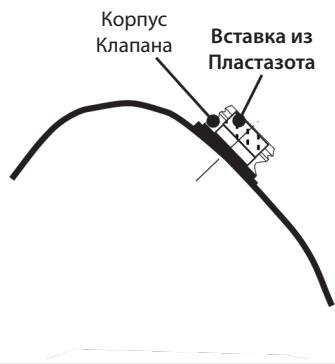
1. Чтобы Носок и Латексный Конус приняли форму слепка включите вакуумную установку и приложите первый вакуум, затем установите Корпус Клапана в требуемое положение с помощью двухстороннего скотча.
