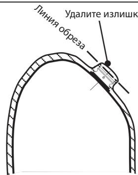
1. Начните изготовление протезной гильзы по методу вытяжки термопластичного материала, при необходимости уменьшите размеры, чтобы можно было изготовить наружную гильзу. Обвязите вокруг корпуса клапана шнур, чтобы обеспечить хорошее уплотнение между телом клапана и протезной гильзой.
