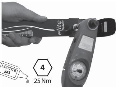
Sæt pylonen på hælens bæreenhed. Påfør Loctite (243), og stram bolten til (25 Nm).
