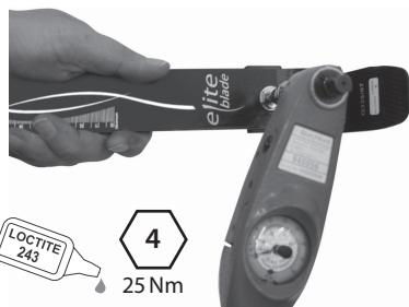
Kiinnitä putki kantaosan kannattimeen. Sivele Loctite-kierrelukitetta (243) ja kiristä pultti (25 Nm).
