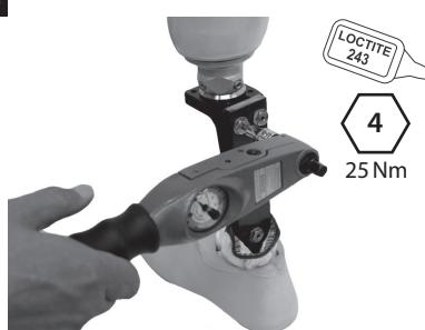
Katkaise putki aikaisemmin kuvatulla tavalla ennen kuin kiinnität sen yläkoteloon. Sivele Loctite-kierrelukitetta (243) ja kiristä pultti (25 Nm). Laita tarvittaessa kosmeettinen osa takaisin paikalleen.
