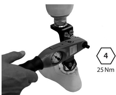
Loctite (243) och dra åt (25 Nm) bultarna på det övre höljet. Montera och rikta in hylsan.
