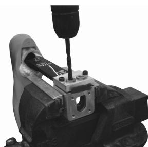
Bor to huller med en diameter på 8,1 mm gennem bøsningerne.
