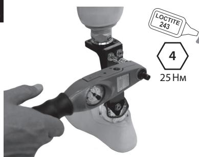
Перед установкой верхнего корпуса, обрежьте мысочную пружину несущего модуля голени. Нанесите резьбовой фиксатор Loctite 243 и затяните болты с усилием в 25 Нм. При необходимости повторно установите косметическую облицовку.
