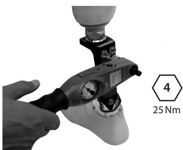
Sivele Loctite-kierrelukitetta (243) ja kiristää yläkotelon pultit (25 Nm). Kiinnitä holkki ja linjaa se.
