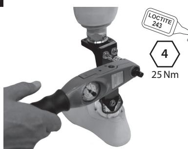
Kutt røret ved bruk av metoden vist tidligere før røradapteren festes. Loctite (243) og tilstrammingsbolter (25 Nm). Sett på det kosmetiske belegget igjen hvis aktuelt.
