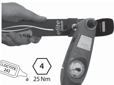
Fest røret til hælens bæredel. Loctite (243) og tilstrammingsbolt (25 Nm).
