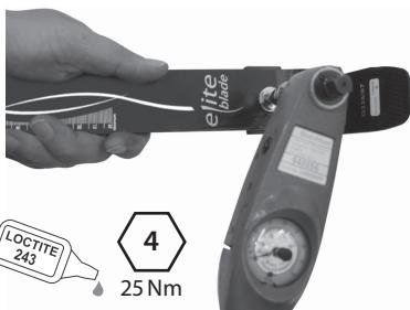
Montera pylonen på hälbäraren. Loctite (243) och dra åt bulten (25 Nm).
