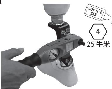
先按之前介绍的方法切割连接管，然后再安装顶部外壳。给螺栓涂抹乐泰 243 防松胶并拧紧至 25 牛米。如果需要，可重新粘合装饰泡沫。
