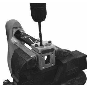
Bruk borhylser og bor to hull med diameter 8,1 mm.
