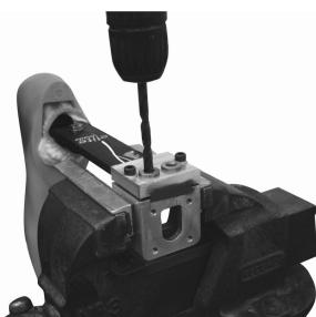
在钻套上钻两个直径 8.1 毫米的孔。
