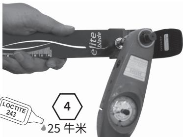
将连接管安装到后跟龙骨上。给螺栓涂抹乐泰 243 防松胶并拧紧至 25 牛米。
